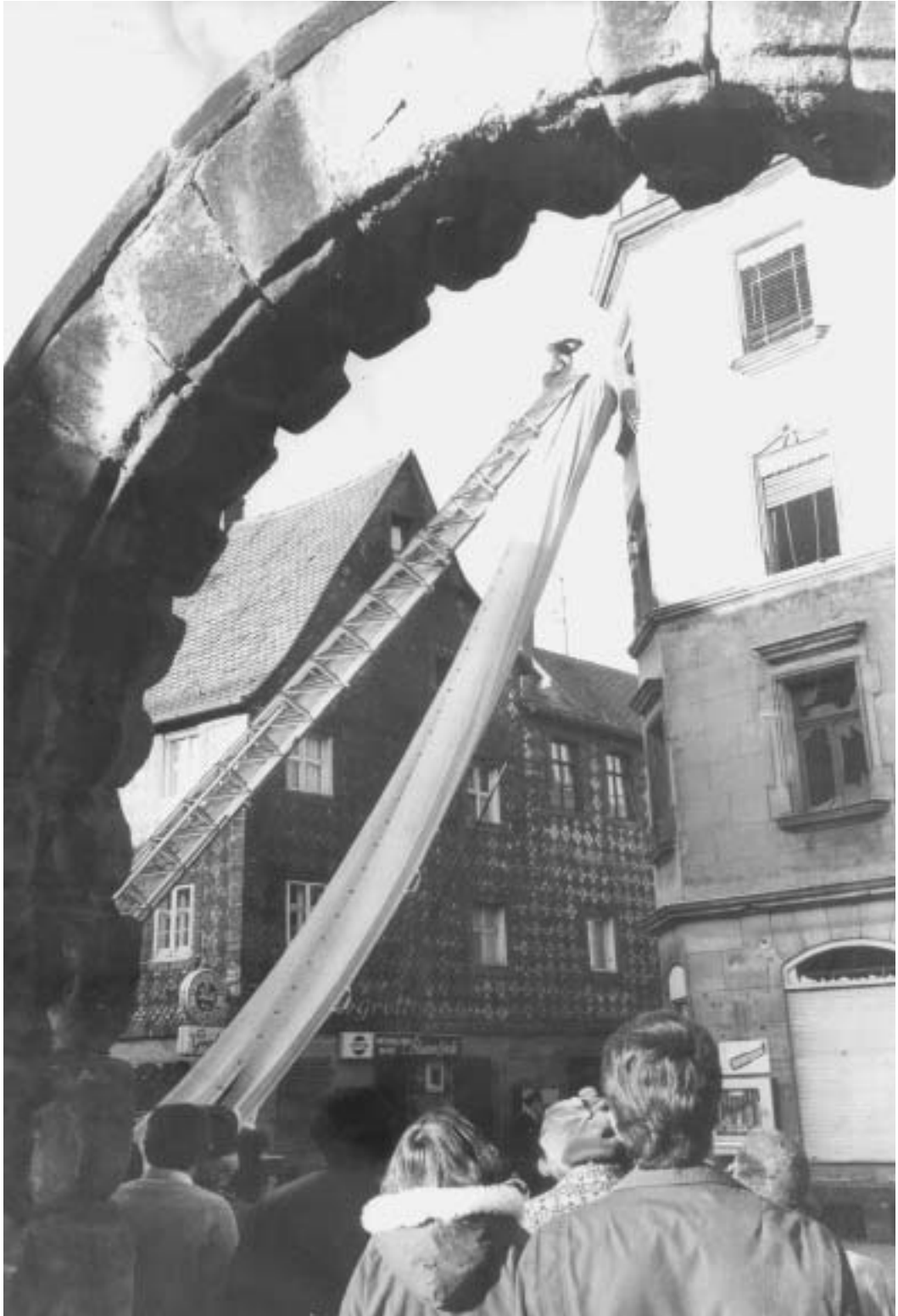
Der Dimpersche Rettungsschlauch im Einsatz.
