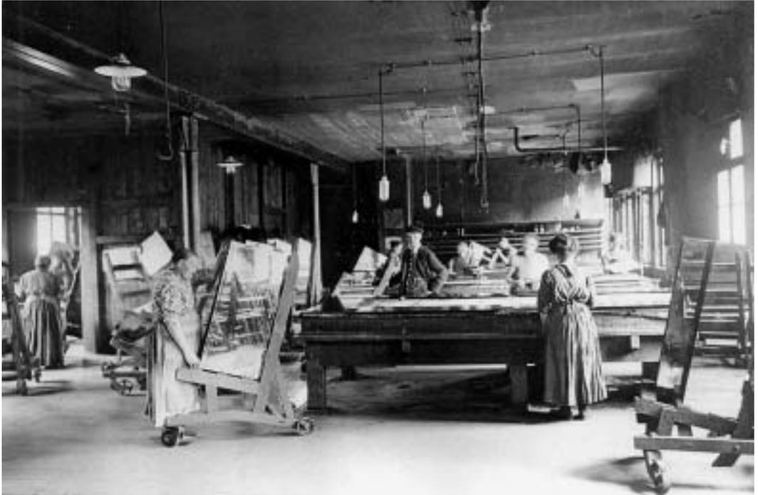
Abb. 4: Lackieren von Spiegeln zur Sicherung der Verspiegelung in der Fürther Rosenstraße 2: vermutlich um 1920.
